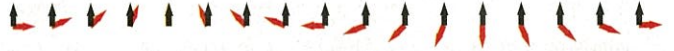
第3図 磁気モーメント(赤)と電気双極子モーメント(黒)の分布。
